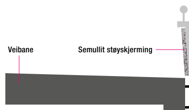
Eksempel på støyskjerming for brukonstruksjon, Nike Arkitektur.
