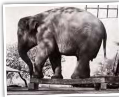
Semullit Takelement hållbarhetstest i Stockholm år 1965 med Skansen-elefanten Gobi (1950 kg).
